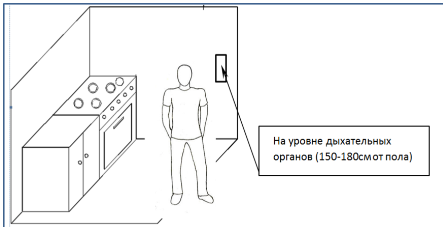
Рисунок 2. Схема расположения газового сигнализатора.
