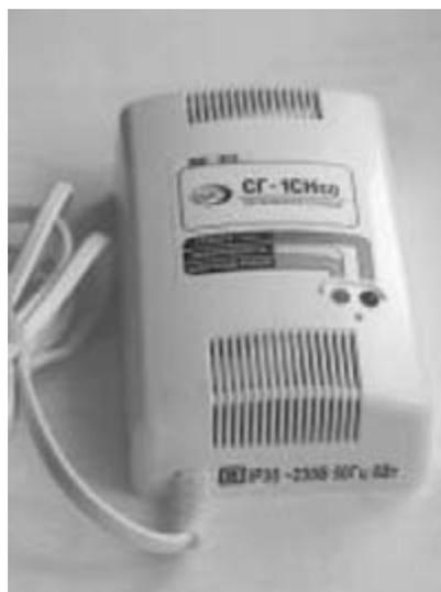
Сигнализаторы газа СГ-1СН предназначены для автоматического непрерывного контроля объемной доли горючих газов (природного газа, сжиженного газа, окиси углерода) и выдачи сигнализации о превышении контролируемых компонентов в воздухе коммунальных, бытовых и производственных помещений.
