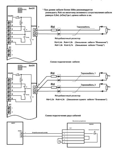
Схема подключения выносного устройства
