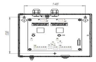
Приложение Б. Габаритные и установочные размеры прибора БиОП исполнение - 01
