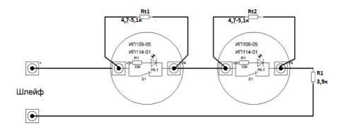
Приложение Ж. Рекомендуемая схема подключения искробезопасного шлейфа к термокабелю.
